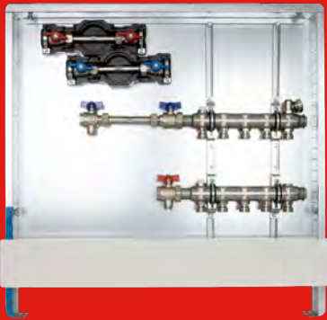
6.1.2 Anschlussstation H 52 im Unterputzschrank 69 Einbauhöhe von OK FFB 640 mm Einbautiefe 110-150 mm
