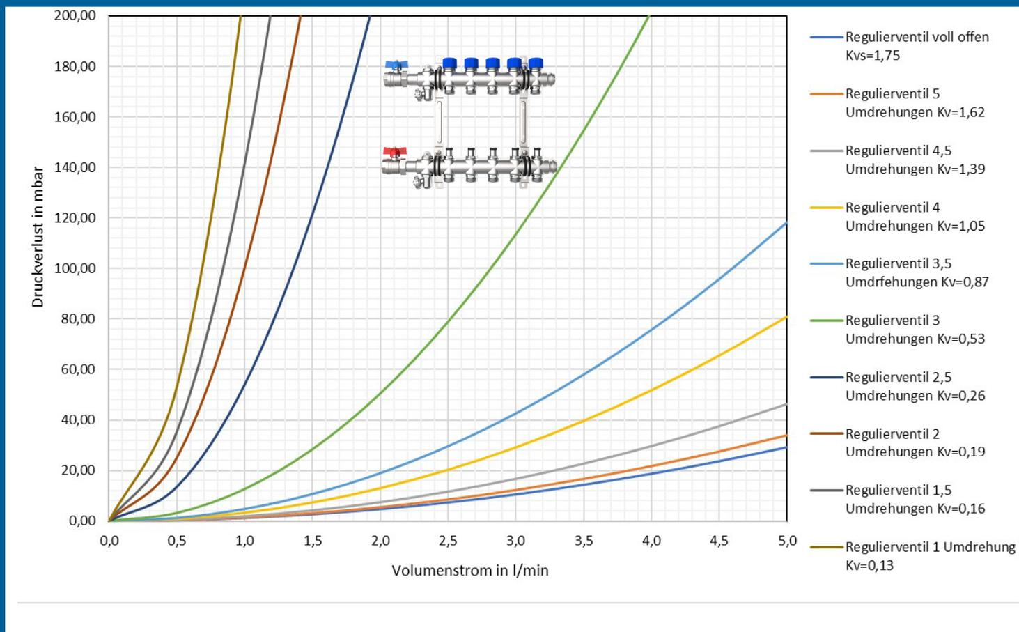
Druckverlustdiagramm e-class 55 pro Heizkreis mit 3/4" Kugelhähnen
