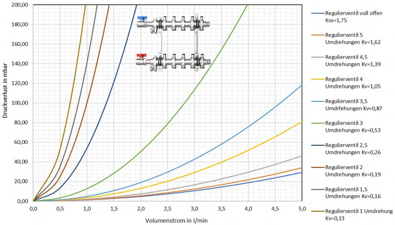
Druckverlustdiagramm e-class 52 pro Heizkreis
