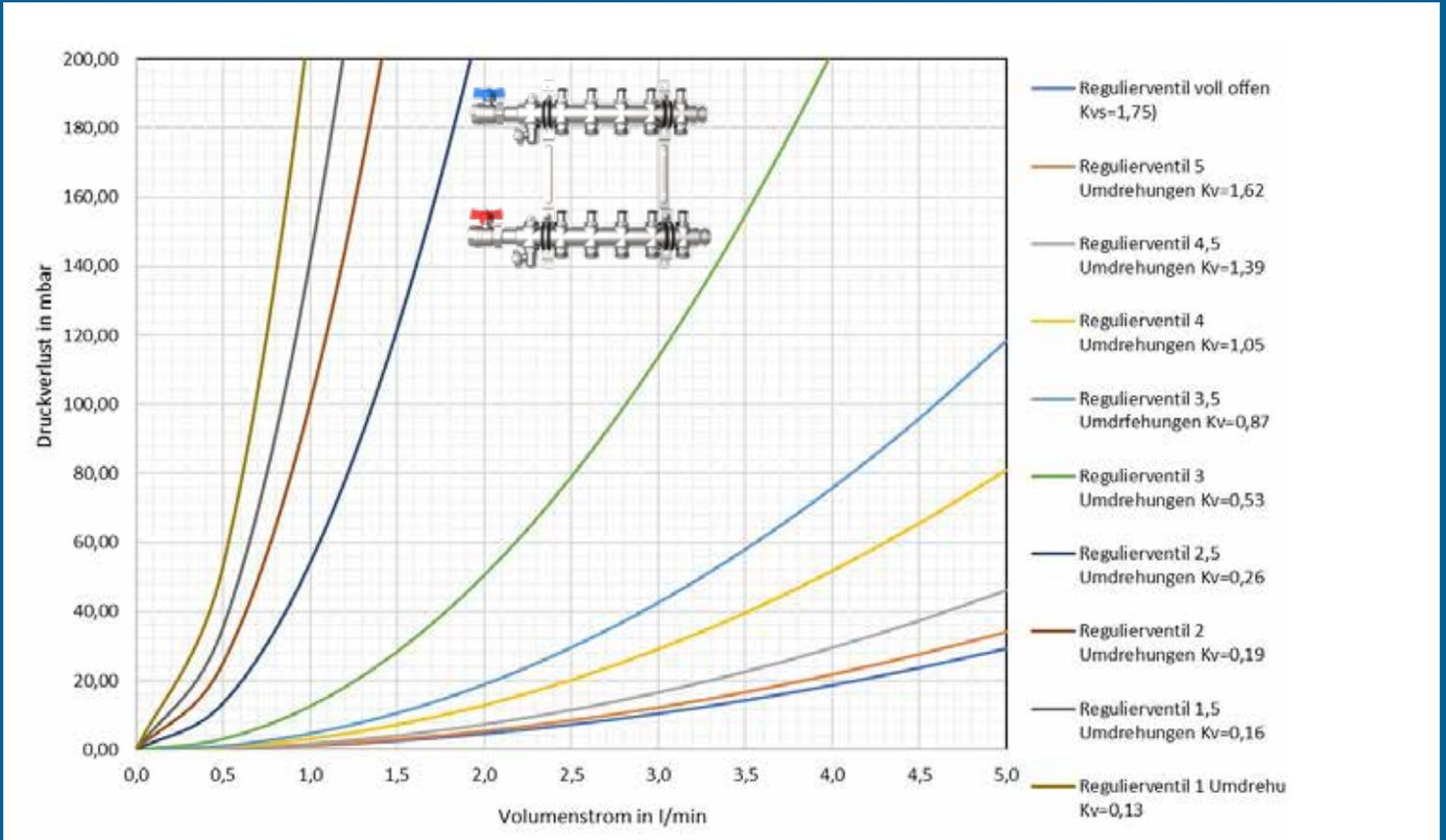
Druckverlustdiagramm e-class 52 pro Heizkreis
