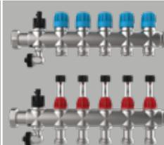
Primäranschluss 1" ÜW fld. horizontal mit Durchflussanzeiger min/max. und THV-Einsatz für EGO-Schnellverschluss ab 10 Hkr.: Primäranschluss 1" AG fld. nach oben mit Durchflussanzeiger min/max. und THV-Einsatz für EGO-Schnellverschluss 2 x flexible Anschlussrohre für Anschluss an Regelgruppe
