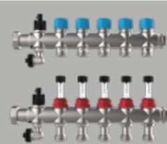
Primäranschluss 1" ÜW fld. horizontal mit Regolux Durchflussanzeiger 0-3 l/min und THV-Einsatz mit Anschlussgewinde M30x1,5 ab 10 Hkr.: Primäranschluss 1" AG fld. nach oben mit Regolux Durchflussanzeiger 0-3 l/min und THV-Einsatz mit Anschlussgewinde M30x1,5; 2 x flexible Anschlussrohre für Anschluss an Regelgruppe
