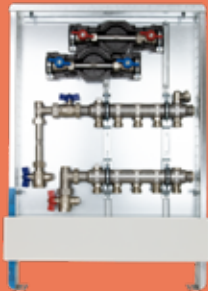
6.1.2 Anschlussstation H 52 im Unterputzschrank 69 Einbauhöhe von OK FFB 640 mm Einbautiefe 110-150 mm
