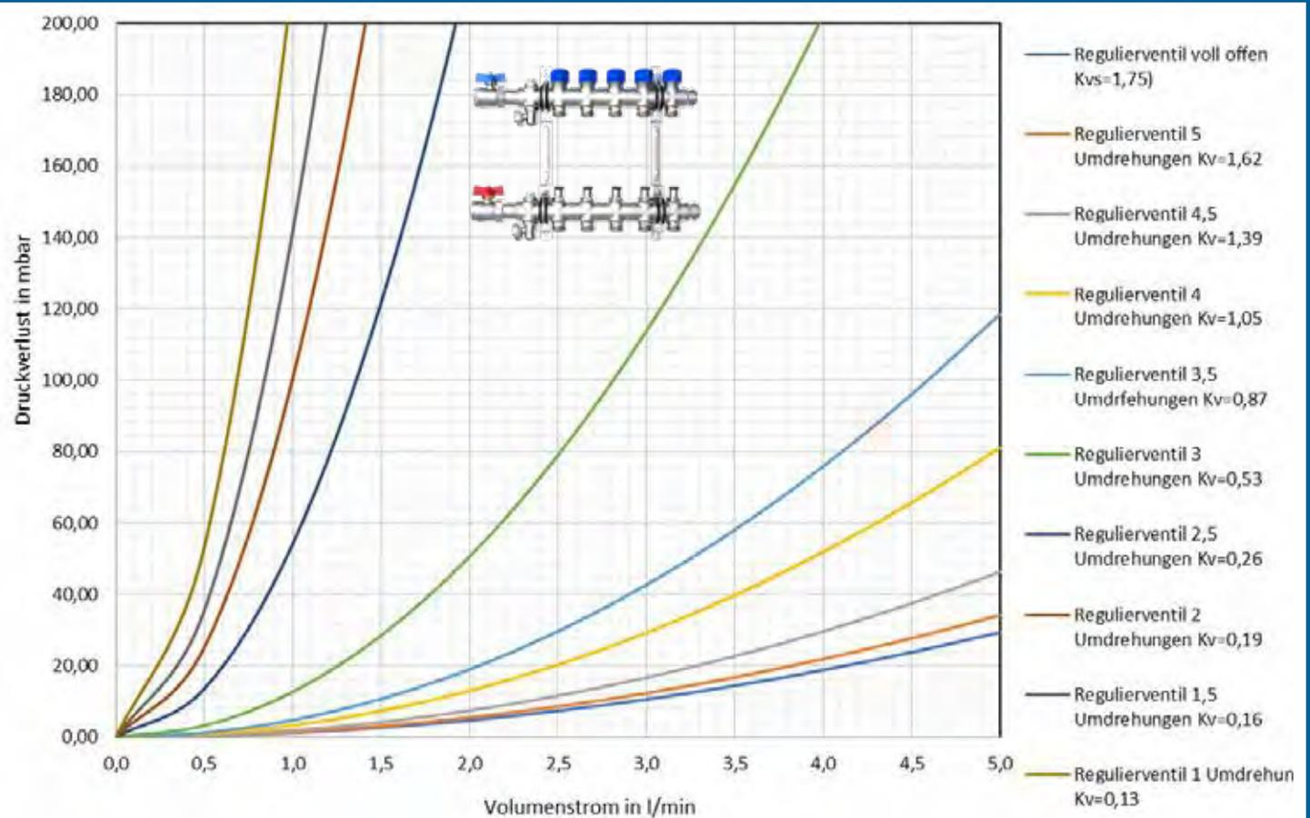
Druckverlustdiagramm e-class 55 pro Heizkreis mit 3/4" Kugelhähnen
