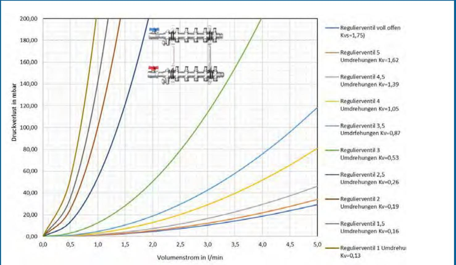
Druckverlustdiagramm e-class 52 pro Heizkreis
