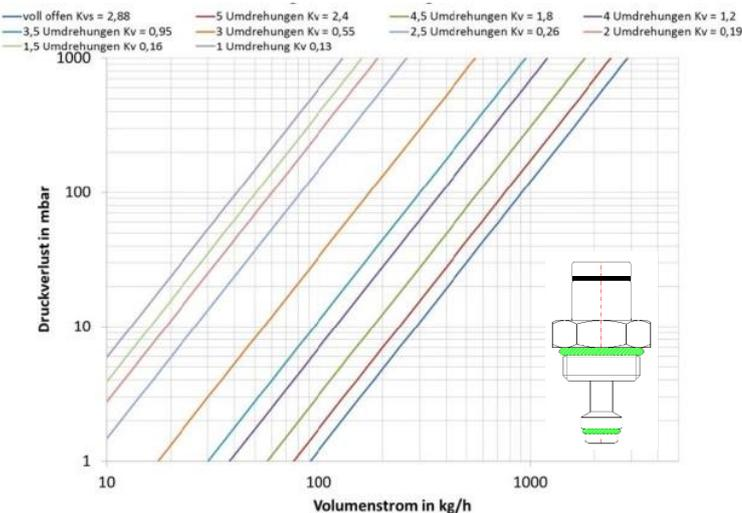
Thermostatventil VA (kvs = 2,56 m³/h)
