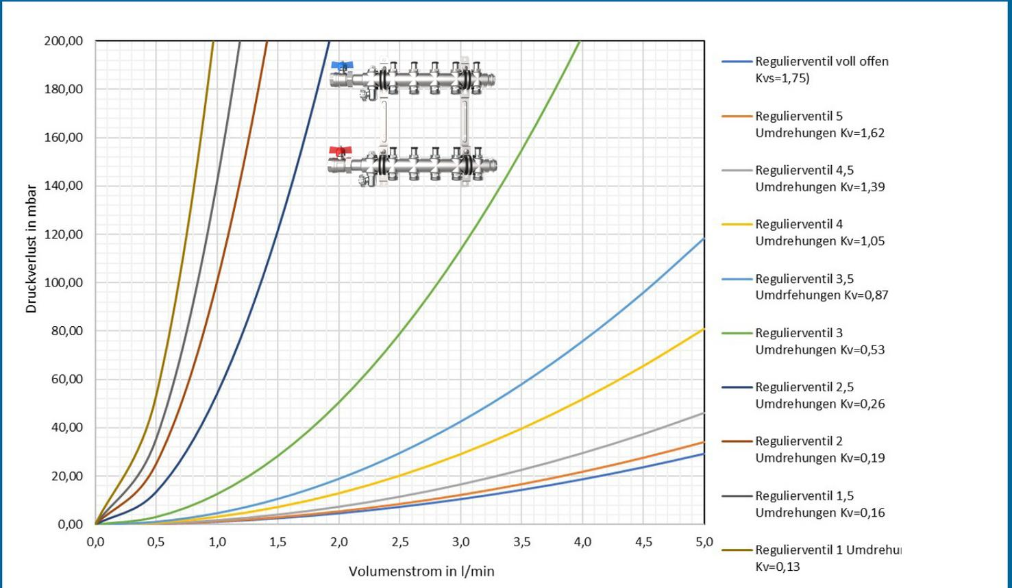
Druckverlustdiagramm e-class 52 pro Heizkreis
